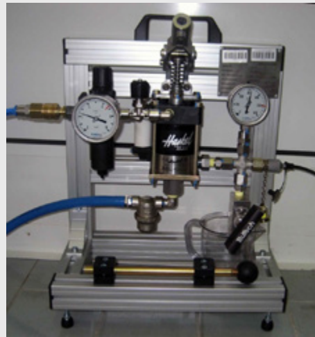
Bild 7: Zur Versuchsdurchführung benutzter Druckübersetzer der Fa. Haskel
